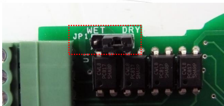
WET (feszültség bemeneti mód) / DRY (kontaktus bemeneti mód) jumper (JP1): DI1-DI8 bemenetekhez
